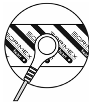
Attēls 1. Vadu un elektrodu savienojuma veids
