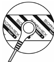
Joonis 1. Juhtme ja elektroodi ühendamise viis
