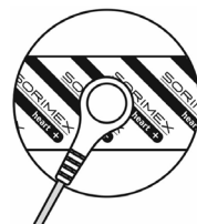
Obr. 1. Spôsob pripojenia kábla k elektróde
