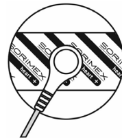
Fig. 1 Comment connecter le fil à l'électrode
