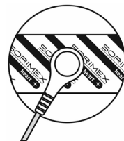
Fig. 1. Modalità di collegamento del cavo all'elettrodo
