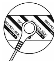
Fig. 1. Método de conexión del cable al electrodo
