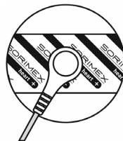
Obr. 1. Způsob připojení vodiče k elektrodě
